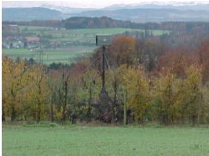
**Abschliessende Versuche mit ALERT - Systemen und Typenwahl. Die Wahl fällt auf das System P-STAR von Lockheed-Martin NESS-Syracuse (N.Y.).** Es wird auf einem speziell ausgerüsteten Standardanhänger 1 t installiert und kann mit einem 8 m Mast ab Anhänger oder mit dem Originalstativ betrieben werden. Es wurde insbesondere darauf geachtet, dass die Einsatz- und Betriebsabläufe im Rahmen der Bedienungsmannschaft mit den-
