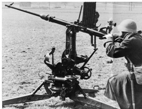
Flab Kan 38 Oerlikon 38 mit Schulterstütze (diese bewährte sich nicht und wurde fallen gelassen)
